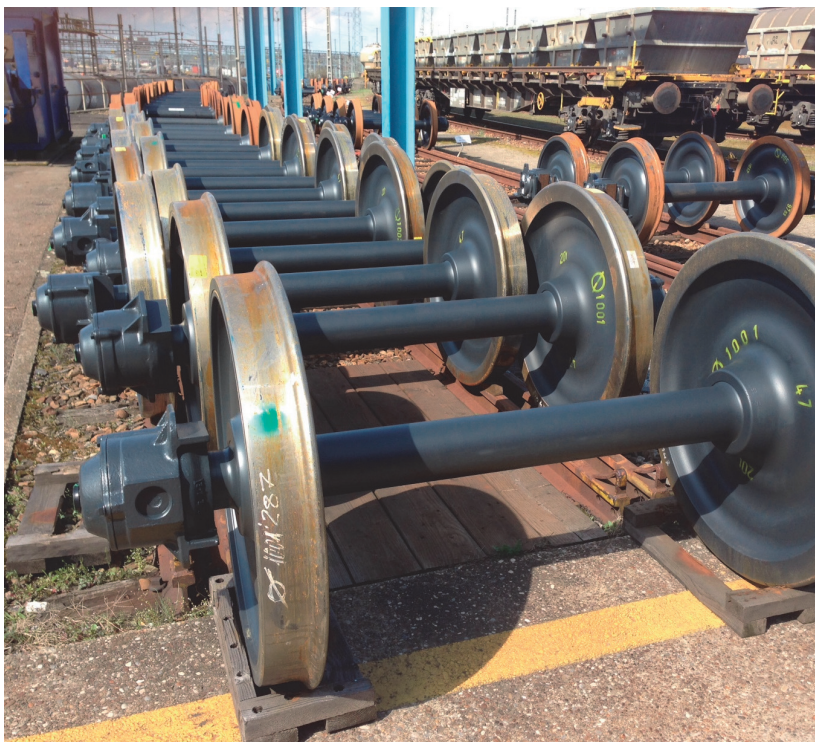
Der Radsatz ist am Güterwagen unumstritten eine sicherheitskritische Komponente. Das ergibt auch die exemplarische Analyse des UIP/VPI-Leitfadens.
