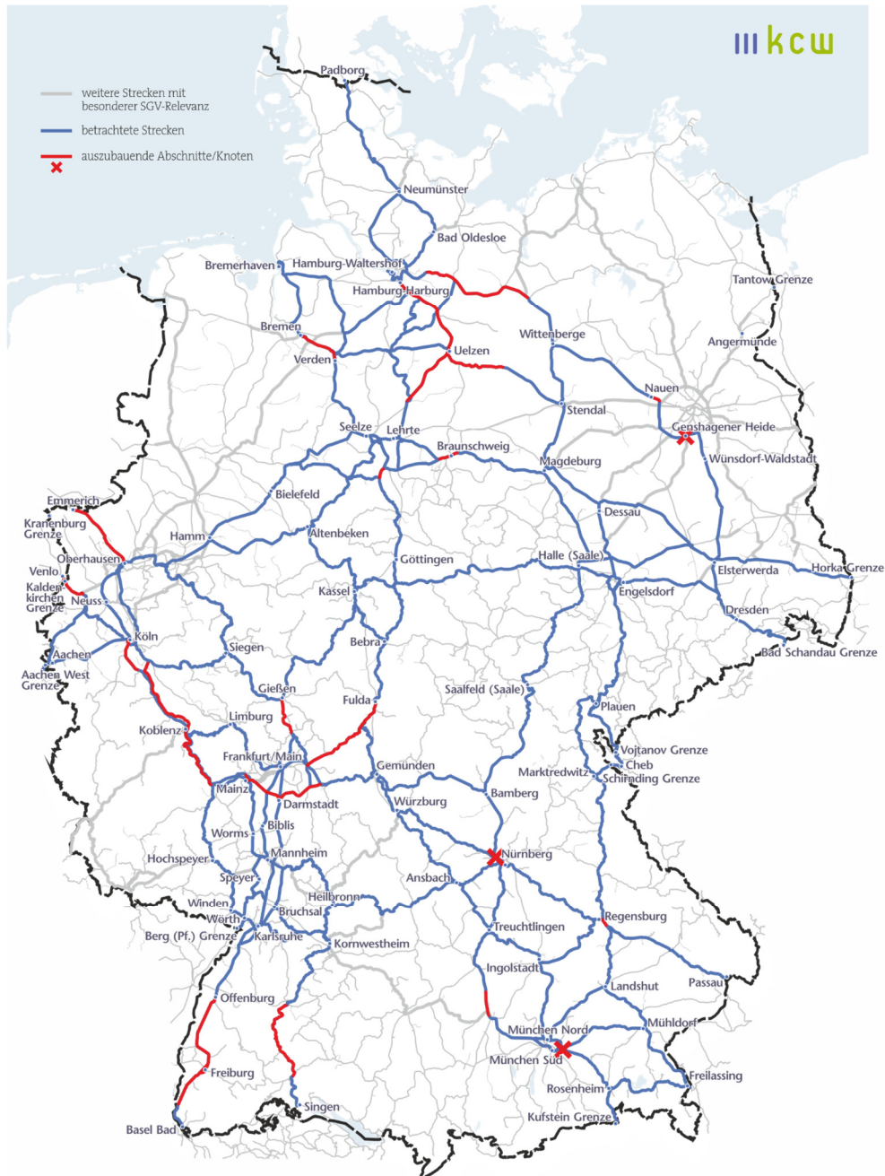
Abbildung 4: Engpässe im SGV-Netz (nach Umroung)
