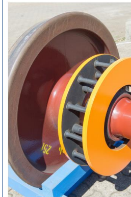
Innovative Scheibe Stahl, geschweißt 86 kg
