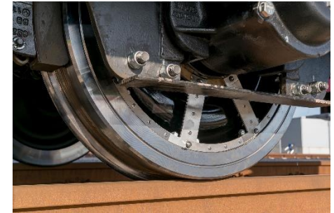
Lucchini mit Hypno-Absorber für klotzgebremste Radsätze (730/760mm)
