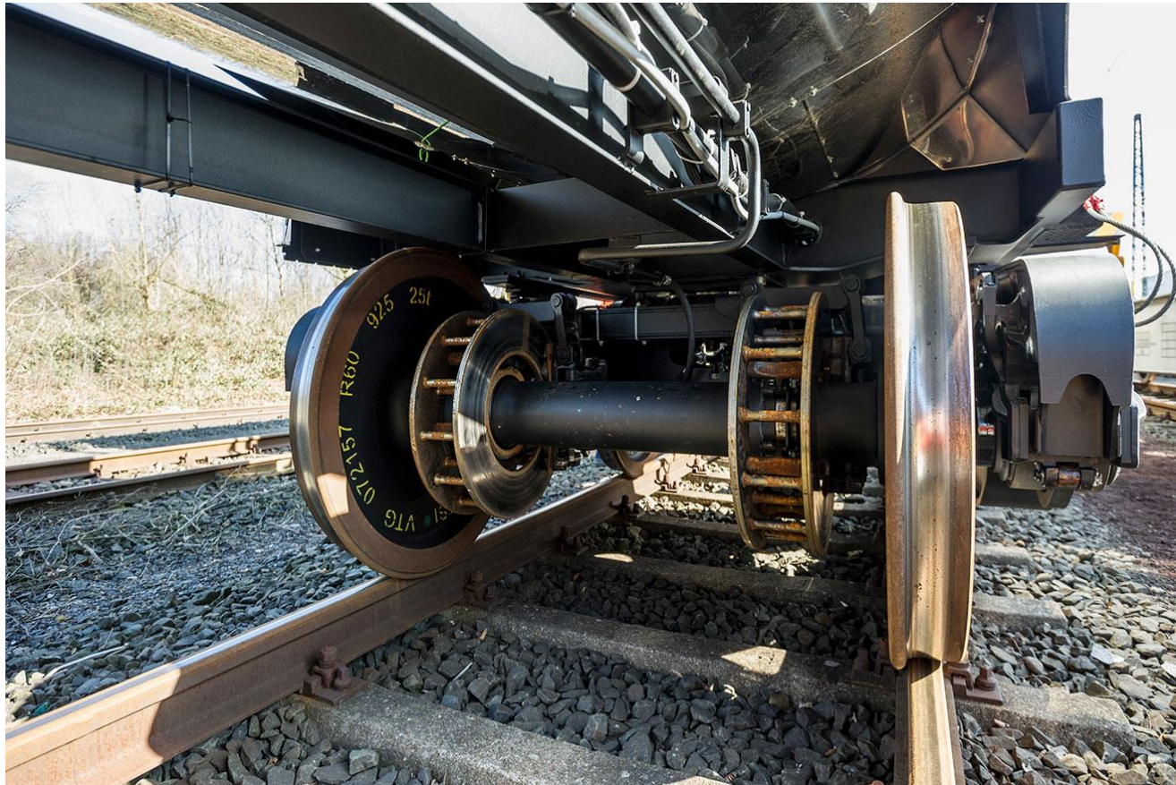
Radsatz mit innovativer Scheibenbremse von Faiveley Transport am IGW Kesselwagen
