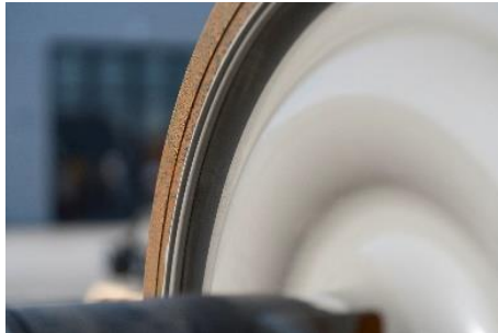
Bonatrans mit Ringelement für klotzgebremste Radsätze (920mm)
