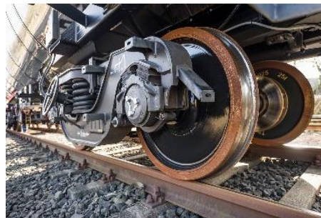
Lucchini mit Syope-Absorber für scheinbgebremste Radsätze (920mm)
