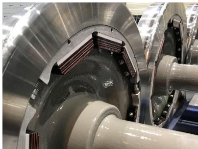
GHH mit Schrey&Veit-Absorber für klotzgebremste Radsätze (920mm)
