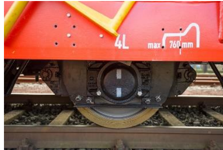
Bonatrans mit Ringelement für klotzgebremste Radsätze (730/760mm)
