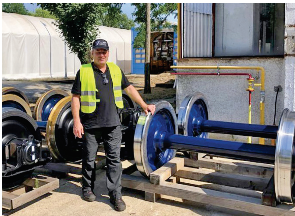
Im Einsatz in Debrecen: Olaf Hingst überprüft die Lackschichtstärke überarbeiteter Radsätze.
