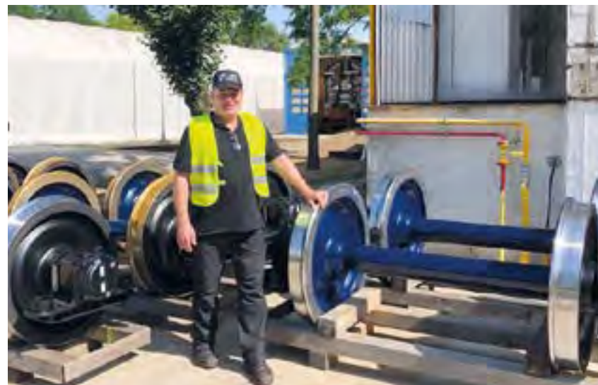
Im Einsatz in Debrecen: Olaf Hingst überprüft die Lackschichtstärke überarbeiteter Radsätze.
